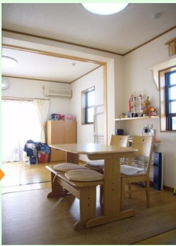
開口フレーム材の厚みを利用して、奥行24cmの小タナを取付け
